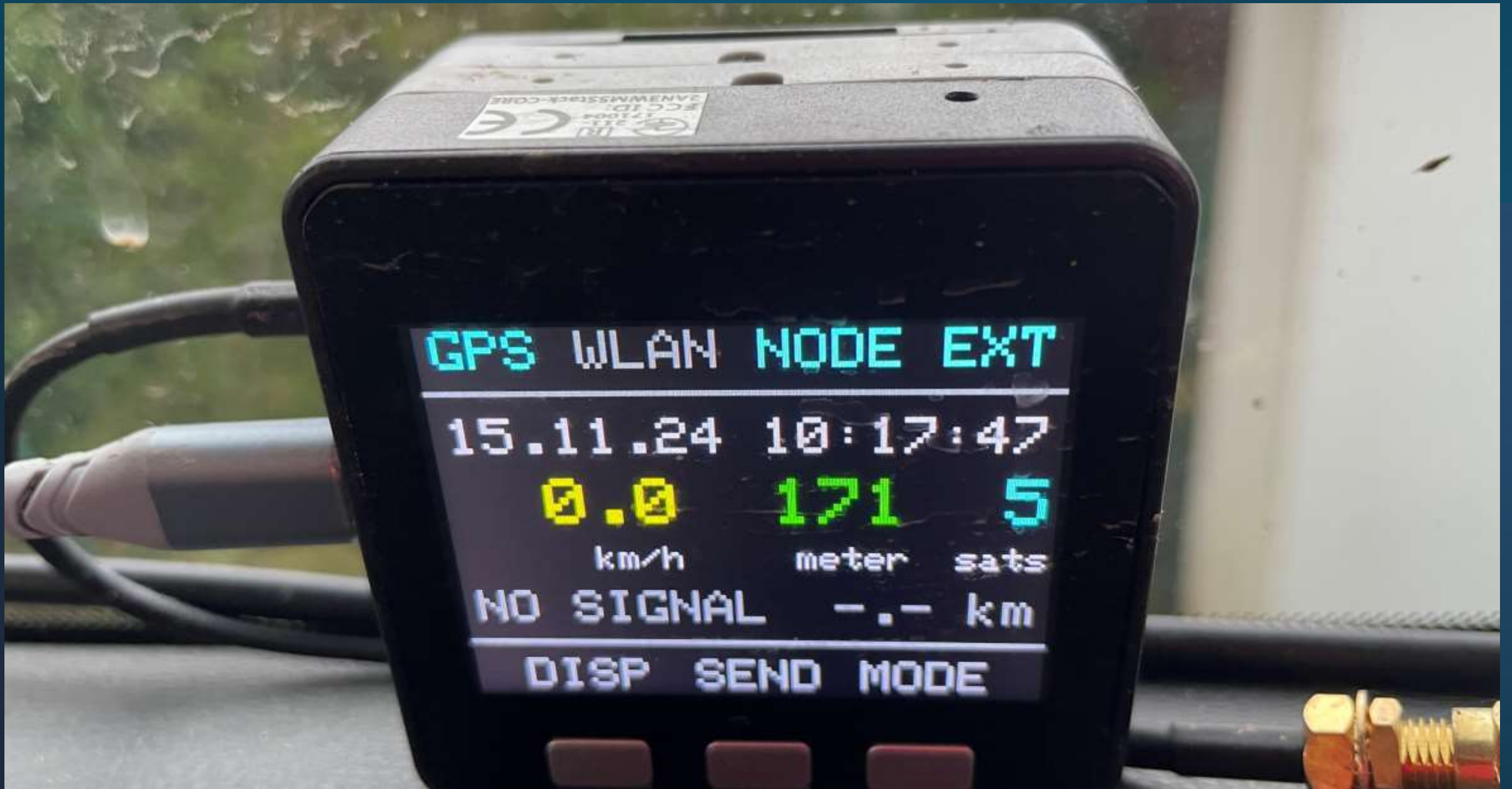
Das sieht dann so aus. Der M5 mit QRO und GPS Modul klebt an der Heckscheibe.
