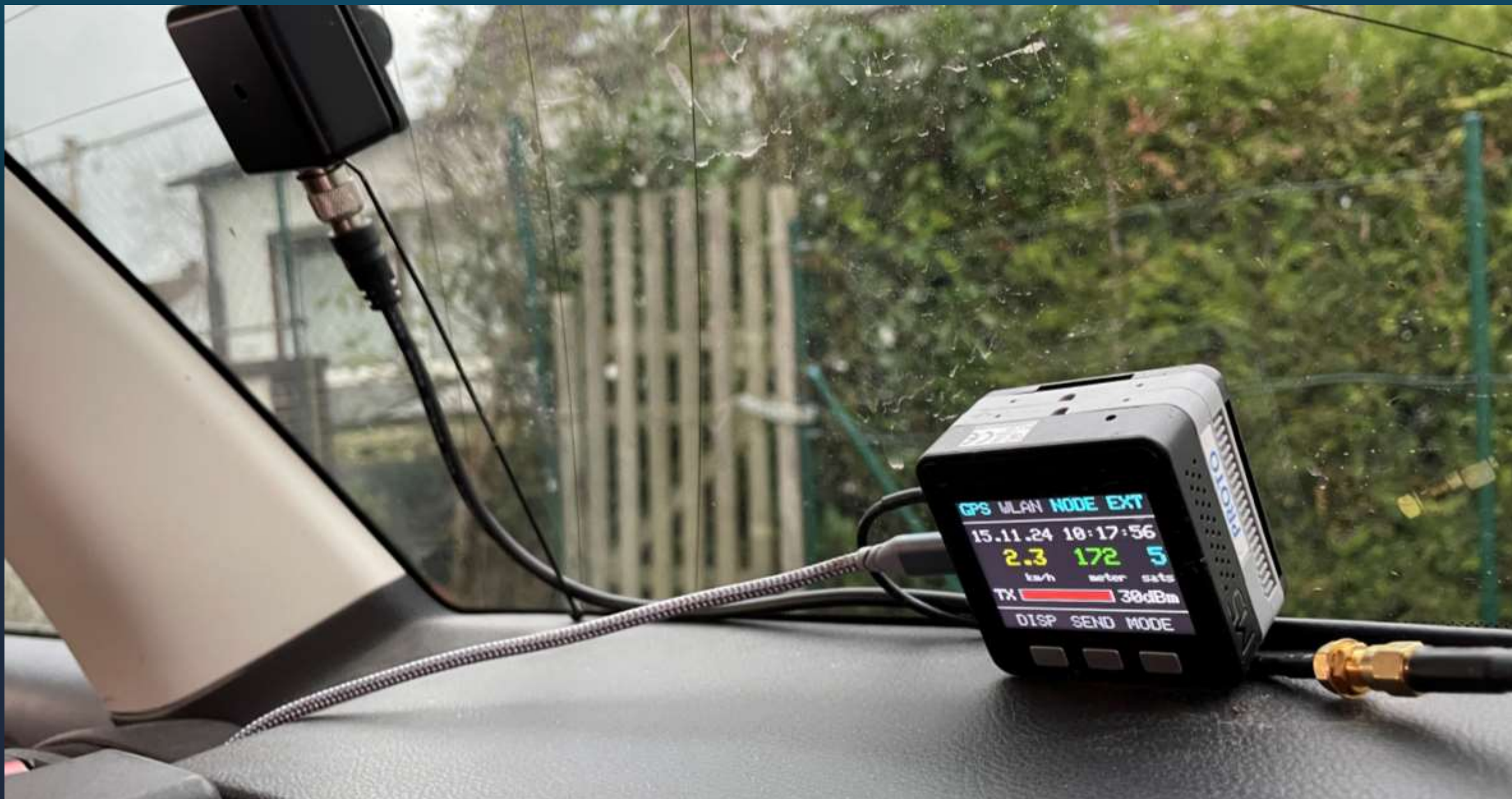
Eine Fensterklebeantenne und 5V aus der USB-Steckdose im Kofferraum
